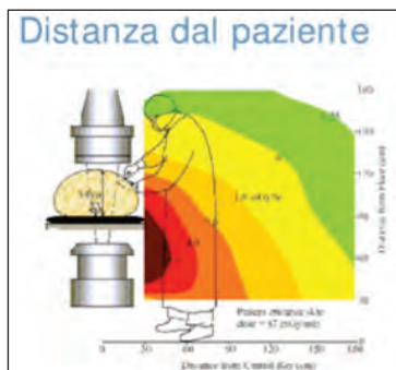
Fig. 2 Esposizione dell'operatore in funzione della distanza dal paziente.
